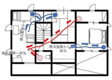
そこで問題は、温度回収による光熱費減と、年中ファンが2台運転される動力費の増加と、更 に設備工事費のアップとを合計し損得を見ないといけません。首都圏などでは暖冷房エネルギー 消費は熱交換効率 60%でも 6%程度の削減にしかなりませんが、3 地域以北では効果的です。 当然、北欧では無くてはならないもので大型のものを設備します。第3種でも給気口フィルター と家のホコリを吸うファンの定期清掃が欠かせませんが、熱交換型では更に熱交換部の清掃が欠 かせません。購入前に施工業者に十分説明を受けて納得してやらないと困ったことになります。
